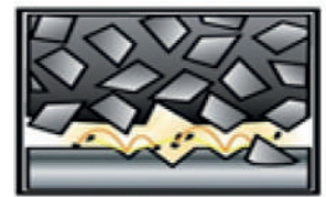
Körelen ilk tane dökülerek zımpara taşıdan uzaklaşıyor. Diğer taneler kesmeye devam ediyor.
