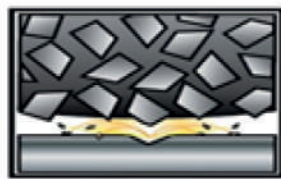
İlk tane iş parçasına dönüyor ve iş parçasından talas kaldırıyor
